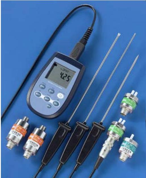
termometri a resistenza elettrica
