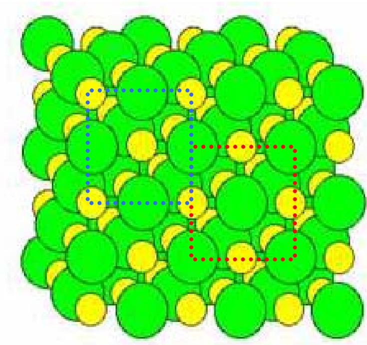
Struttura di NaCl
